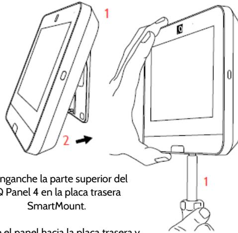
1. Enganche la parte superior del IQ Panel 4 en la placa trasera SmartMount.
