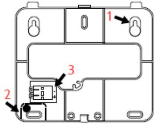
1. Fije la placa trasera a la pared con tornillos #6 de cabeza plana y anclajes adecuados si es necesario, asegurándose de que esté nivelada.
