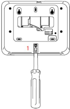
1. Con un destornillador Phillips pequeño, afloje el tornillo de bloqueo de la parte posterior del panel y retire la placa trasera SmartMount.
